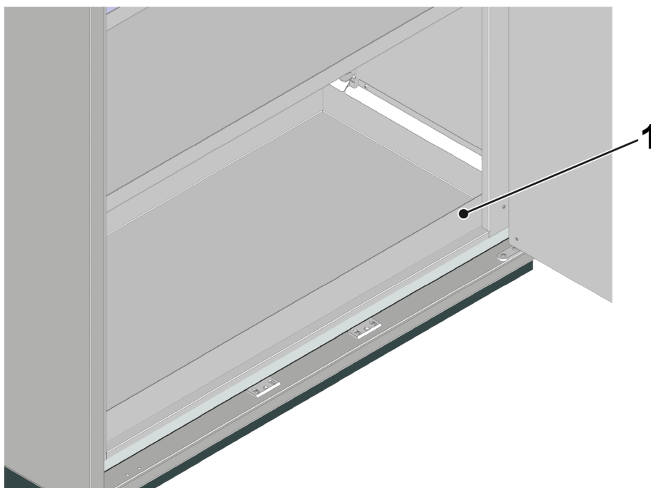
Fig. 11: Bac de rétention
