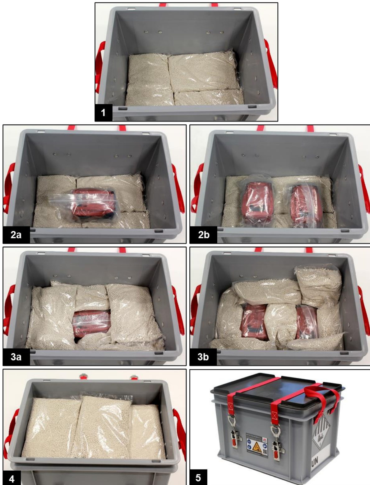
Abb. 3: Verpacken von Lithium-Ionen-Batterien in einer BATTERY Transportbox S
