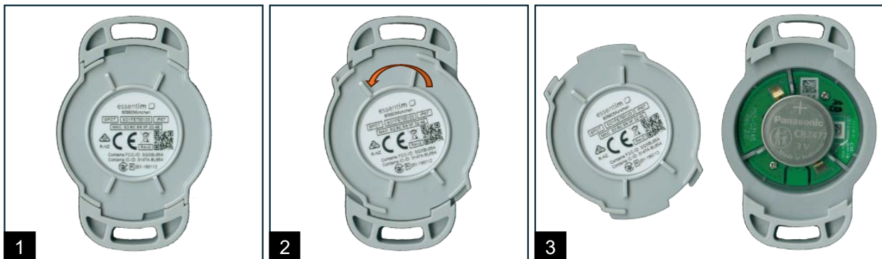
Abb. 2: Batterie in Spot einlegen
